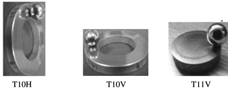
Fig. 1. Position of friction contact in T10 and T11 tribotesters Rys. 1. Ustawienie węzła tarcia w testerach T10 i T11
